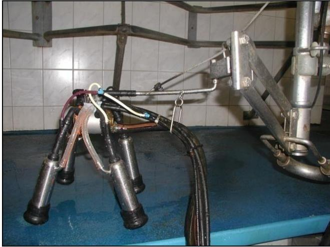
**Abbildung 1: Versuchsaufbau des AktivPuls-Melkzeuges**
