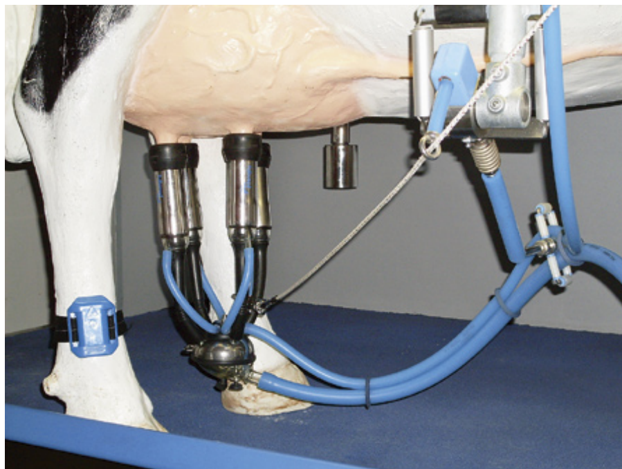
Die einfachste Möglichkeit der Zitzenschonung: Gleichtakt pulsation und Anheben der Milchschräuche.
