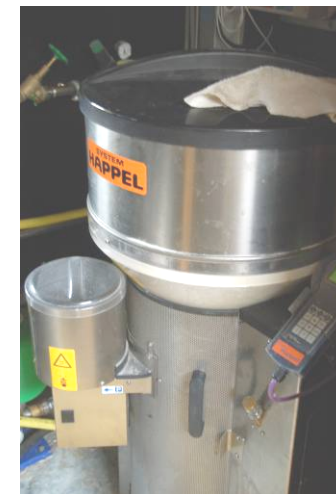
Der Tränkeautomat ist frostsicher
