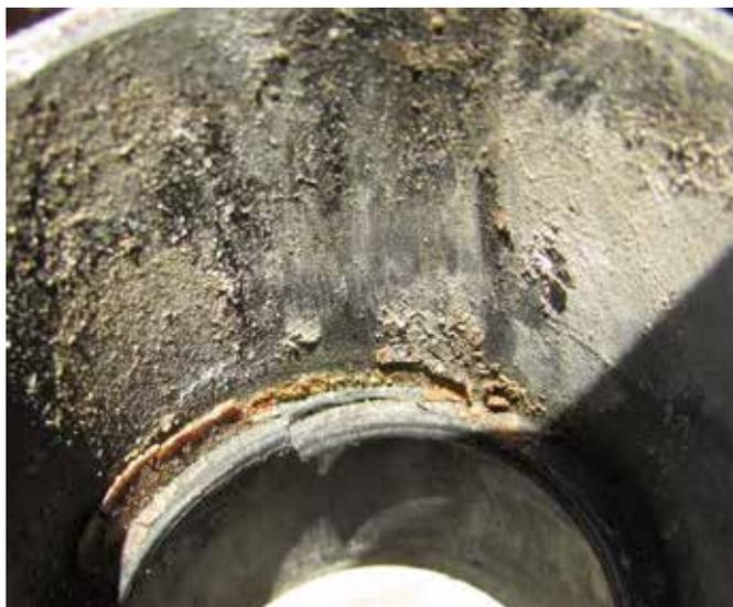
Abbildung 7: Defekte Dichtung aus Milchleitung mit Ablagerungen.
