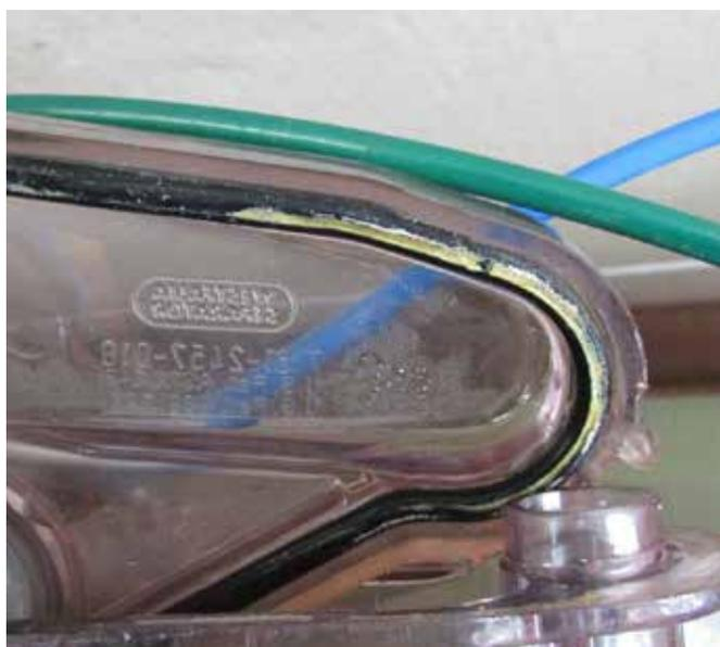
Abbildung 3: Ablagerungen in einem Milchmengenmessgerät durch eine Propionsäuregärung.
