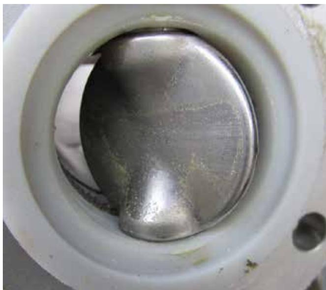
Abbildung 4: Ablagerungen beim Klappenventil eines Milchsammeltanks.
