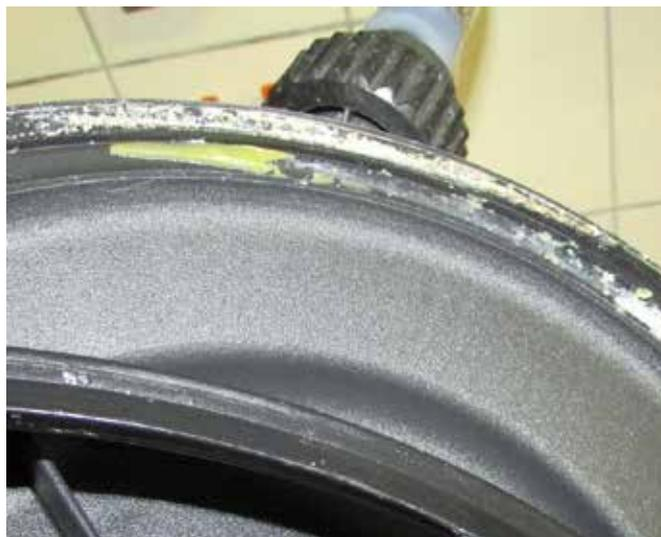
Abbildung 5: Ablagerungen unter Gummidichtung eines Deckels der Endeinheit.
