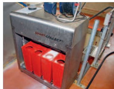
Milch, die nicht in den Tank gemolken werden darf, kann über eine Separationseinrichtung getrennt werden.
