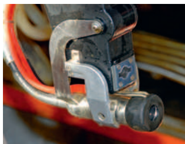
Der Roboterarm mit dem Vormelkbecher, oberhalb sind Kamera und Laser positioniert.
