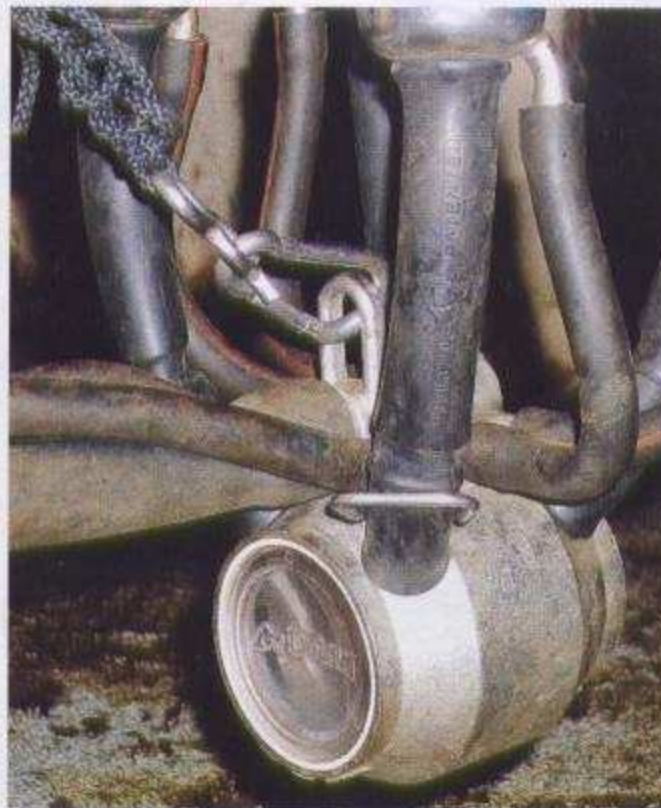
Das zentrale Steigrohr beim MC 73, DeLaval, dämpft das Vakuum.
