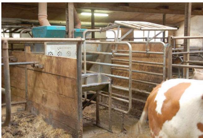
Die gegenüberliegenden Kraftfutterautomaten werden nach dem Betreten automatisch per Luftdruck mit einer Heckklappe geschlossen; wegtreiben der Kühe wird so wirksam verhindert. Jeweils an der Rückseite ist ein praktisches Tränkebecken angebracht.
