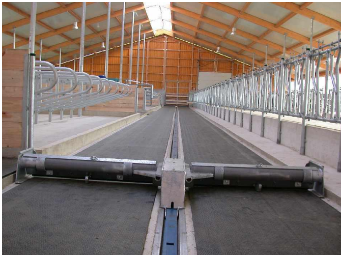
Hydraulisch wird der Schieber vor- und zurück geschoben.
