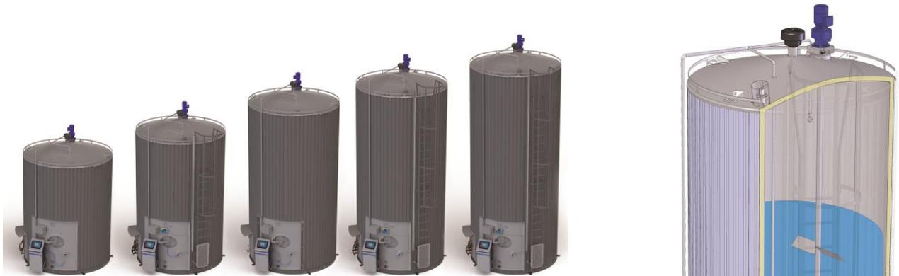
Der Milchkühltank besitzt einen Innenraum aus Edelstahl (AISI 304). Die am Tankboden und Mantel angebrachten Verdampfer bürgen für eine optimale Verdampferoberfläche im Verhältnis zur erforderlichen Kühlleistung in Anpassung an die Größe und Melksysteme der Betriebe. Der konisch zulaufende Tankboden ist auf einen reibungslosen Start der Kühlaggregate bei kleinen Milchmengen ausgelegt (200 bis 500 Liter).
