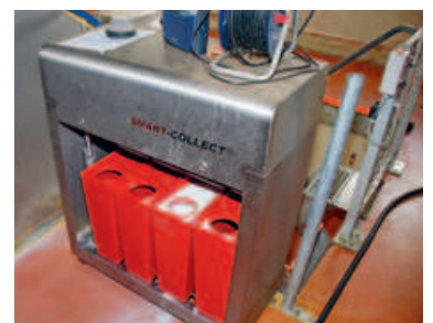
Milch, die nicht in den Tank gemolken werden darf, kann über eine Separationseinrichtung getrennt werden.
