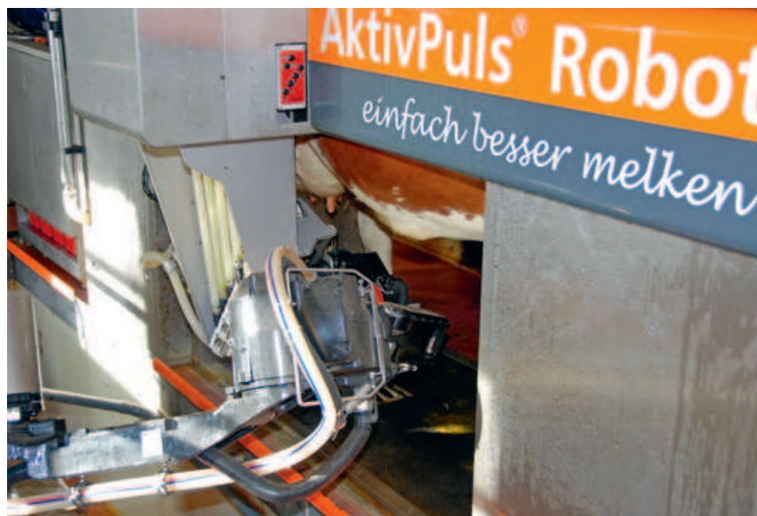
Die Melkbox, aus Edelstahl gefertigt, mit dem Roboterarm, der auch zwei Boxen bedienen könnte.
