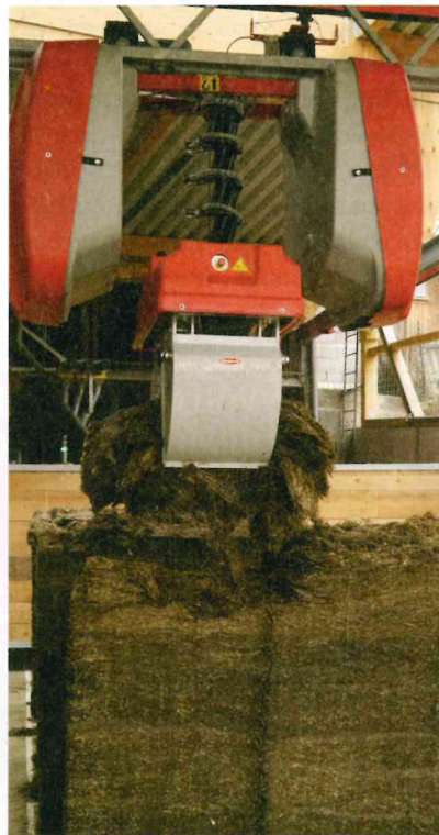
Völlig selbständig räumt z.B. der Lely Vector das Futter ans Fressgitter und legt bei Bedarf eine frische Ration vor.
